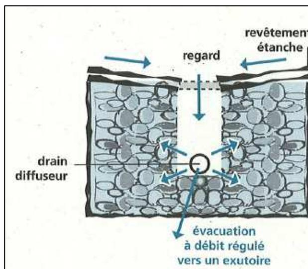
**SCHEMA DE PRINCIPE – TOITURES STOCKANTES**
